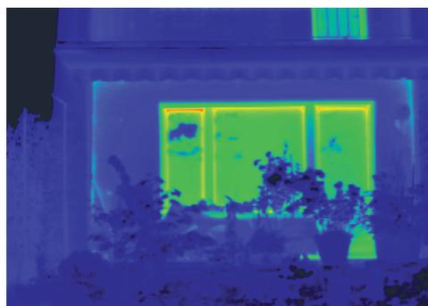
Nach dem sorgfältigen Einbau neuer Schüco Corona CT 70-Fenster beweist die Thermografie den hohen energetischen Nutzen der Investition. Der ursprüngliche Energieverlust wird nahezu vollständig vermieden.
